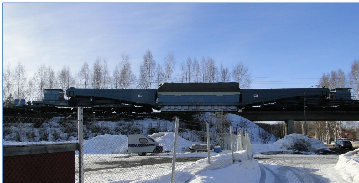
Transport av transformator från ABB i Ludvika, vikt: 393 ton (Bildkälla: ABB)
